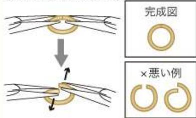
平ヤットコ2本を両手で持ち、両方のヤットコでカンの切れ目の両側を挟む。片方の手を手前に、もう片方の手を奥に動かすようにしてつなぎ目を前後にずらしカンを開く。
