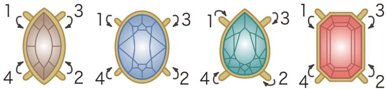
石座に水平になるように乗せ、図の順で平ヤットコでツメを倒す。
