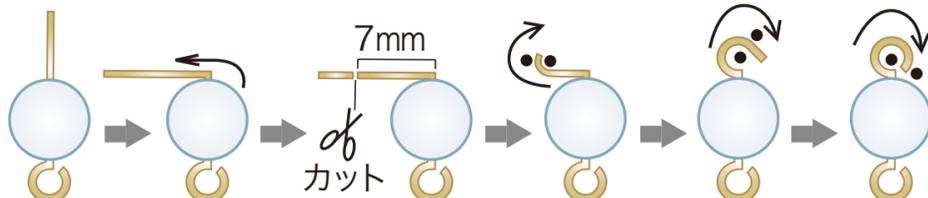
ピンにパーツを通し、ピンの根元を直角に折り曲げ根元から7mm程残しニッパーでカットする。ピンの先を丸ヤットコで挟み手首を返すように手前にゆっくり丸めて完成。
