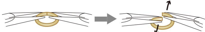
平ヤットコ2本を両手で持ち、両方のヤットコでカンの切れ目の両側を挟む。
